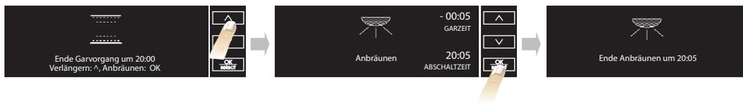
Nach dem Ablauf der Garzeit zeigt das Display „^ Verlängern OK Bräunen“. Nach dem Drücken der Taste  startet der Ofen die Bräunungsphase, die 5 Minuten dauert. Diese Funktion kann nur einmal ausgeführt werden.
