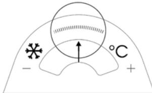
Befindet sich der Zeiger im mittleren Bereich, ist die Temperatur richtig.
